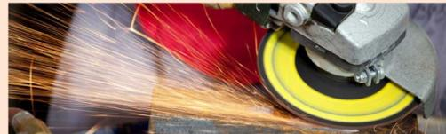
La proiezione di schegge metalliche incandescenti o di gocce di metallo fuso contro le superfici in vetro causano danni permanenti dato che il particolato metallico fonde superficialmente il vetro e si incastona in esso
