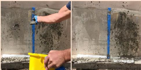
La natura alcalina del cemento aggredisce in maniera permanente la superficie del vetro
